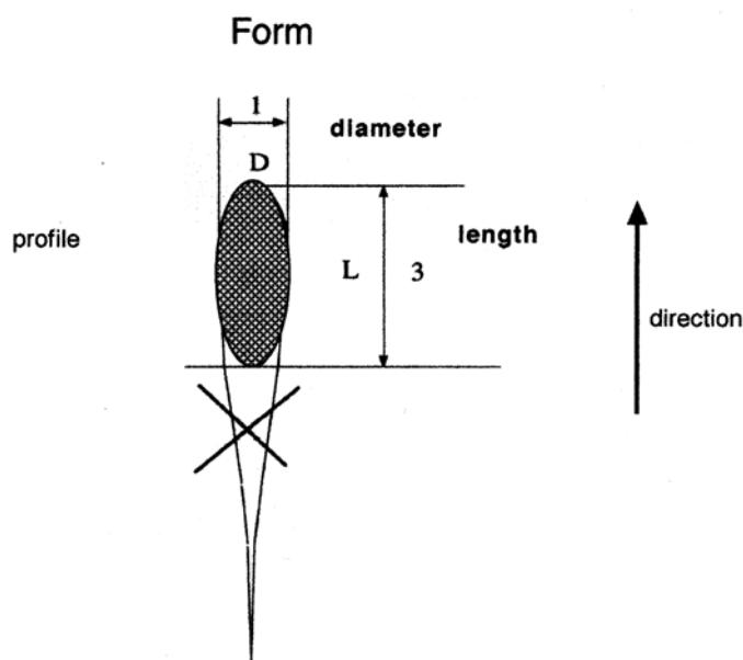
Αεροδυναμικό πρόσθετο ορίζεται η προέκταση ή επιπλέον αεροδυναμική σχεδίαση ενός εξαρτήματος. Αυτό είναι σε ανεκτό πλαίσια εφόσον ο λόγος του μήκους  $L$  και της διαμέτρου  $D$ , δεν υπερβαίνει το 3.
